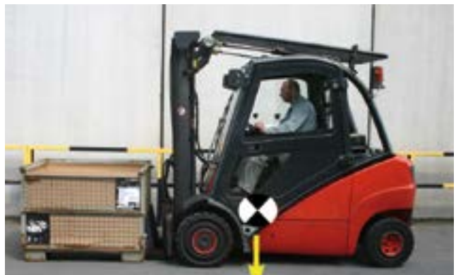
Bild 6-21: ... ergeben den Gesamtschwerpunkt bei abgesenkter Last
