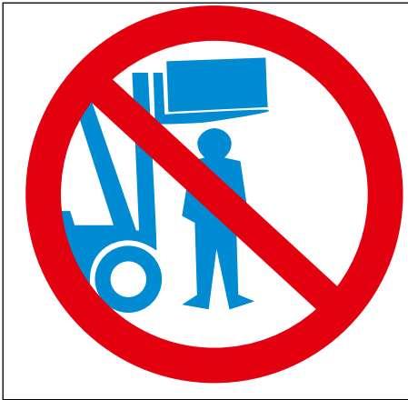
Bild 2-3: Anschlag „Aufenthalt unter der Last verboten“
