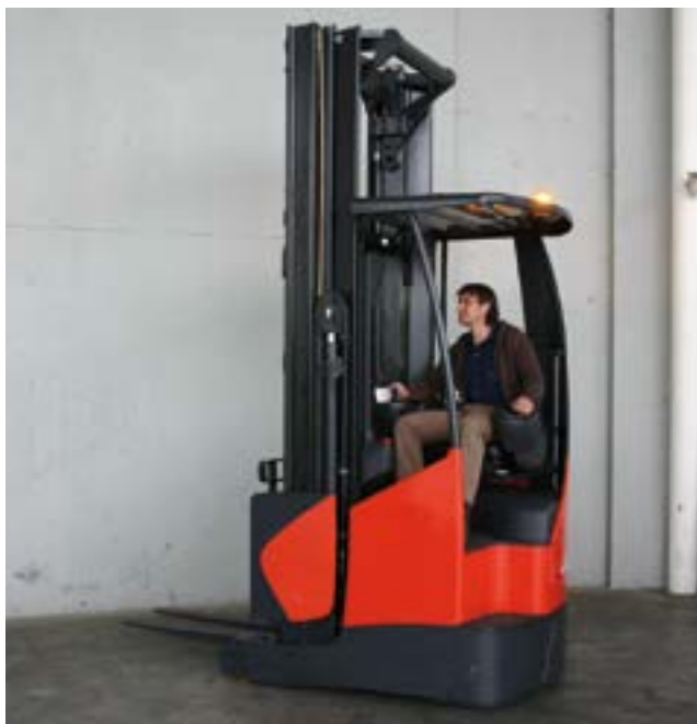
Bild 6-16: Für regelmäßiges Rückwärtsfahren geeigneter Quersitzstapler
