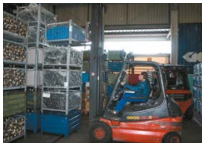
Bild 6-15: Nur zum Auf- und Absetzen mit hoch gestellter Last verfahren
