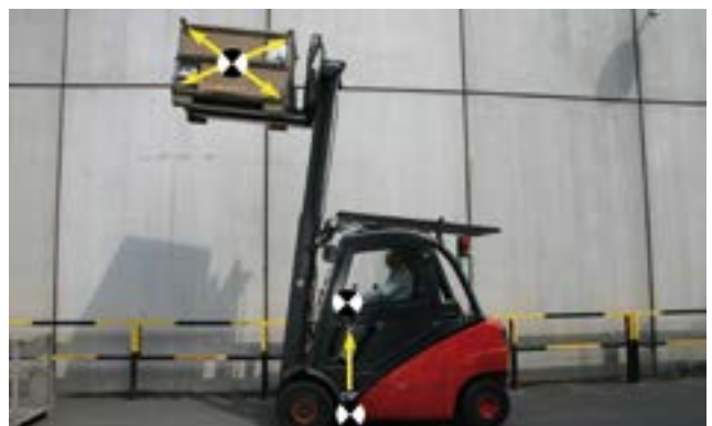
Bild 6-22: Verlagerung des Gesamtschwerpunktes bei angehobener Last
